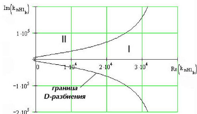
Рисунок 1.3.7 - D-разбиение в плоскости коэффициента k_{нН1} : I – область устойчивой работы; II – область неустойчивой работы САР
