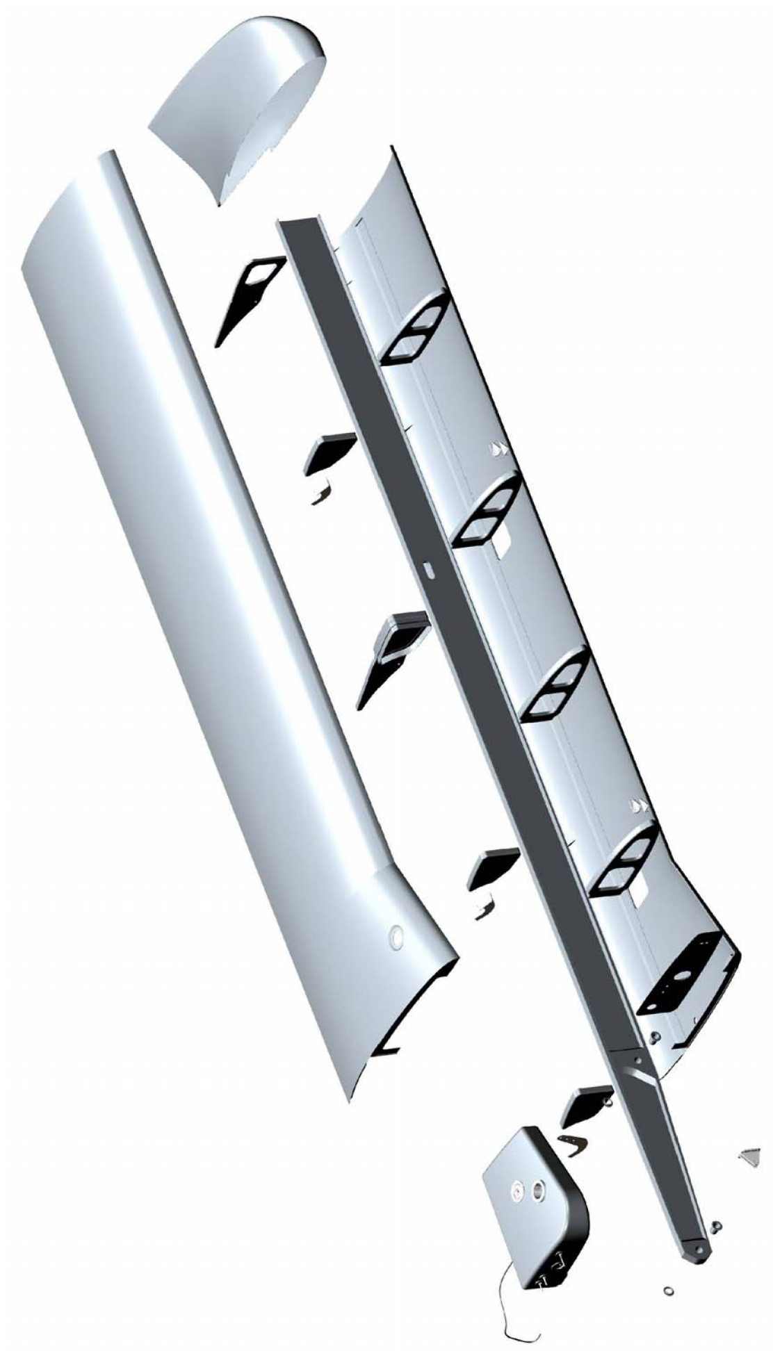
Рисунок 42 – Схема членения крыла лёгкого самолёта.
