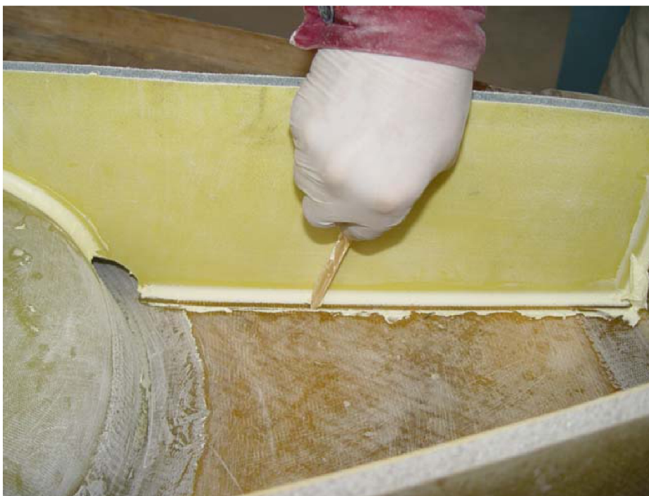
Рисунок 32 – удаление излишков клея.
