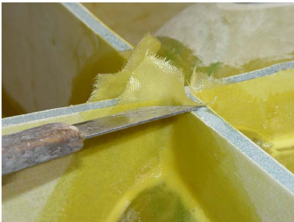
Рисунок 34 – Удаление излишков уголка.
