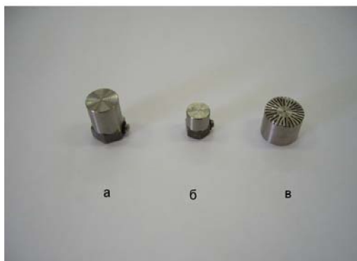
Рисунок 4.1 - Пьезоэлектрическими виброизмерительными преобразователями ДН-3-М1 (а), ДН-4-М1 (б); микрофонный конденсаторный капсюль М101 (в)
