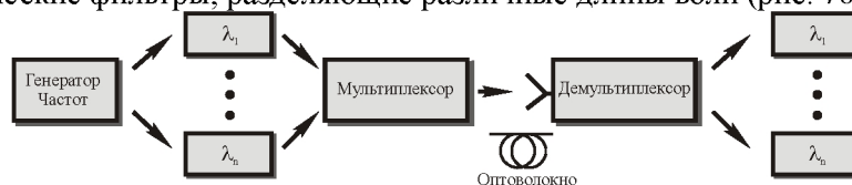
Рис. 78. Блок-схема телекоммуникационной WDM-системы
