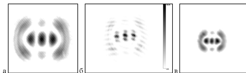
Рис. 53 Результаты исследования ДОО, формирующего распределение, описываемое суммой двух мод Гаусса — Эрмита с номерами (2,2) и (4,0): а) амплитуда в сечении сформированного пучка (восстановлена по результатам измерения интенсивности); б) результат интерферометрического исследования фазы пучка; в) амплитуда в сечении пучка после прохождения Фурье—каскада (восстановлена по результатам измерения интенсивности)
