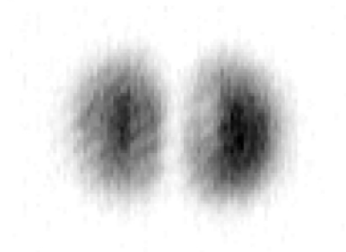
Рис. 17. Интенсивность пучка после прохождения Фурье-каскада
