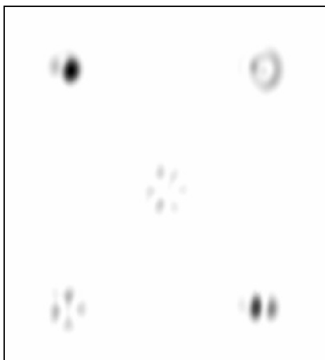
Рис. 96. Распределение в корреляционном поле при сдвиге входного торца
