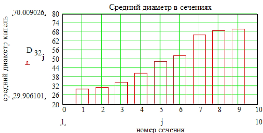
Рис. 14 Результаты расчета среднего диаметра (по-Заутеру) для точек сечения x=365 мм
