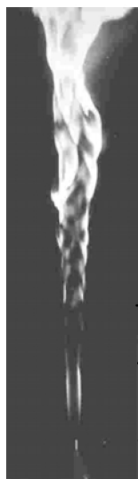
Участки пламени: 1 – ламинарный; 2 – переходный; 3 – турбулентный.
