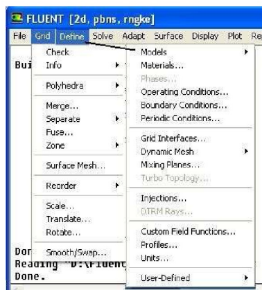
Рис. 1.4. Подменю подготовки расчетной модели (Grid и Define)
