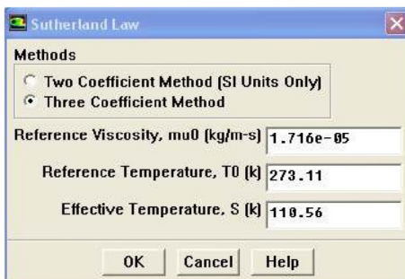
Рис. 2.14. Меню настройки зависимости вязкости от температуры с помощью уравнения Сатерленда
