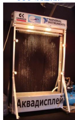
Аквадисплей – мехатронное устройство для демонстрации водой графических изображений
