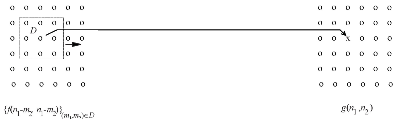
Рисунок 7.1 - Схема обработки изображения в скользящем окне
