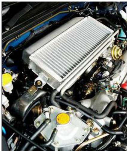
Рисунок 2.2 – Интеркулер (промежуточный охладитель наддувочного воздуха) в подкапотном пространстве двигателя
