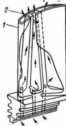
Рисунок 3.2.2 – Канальная лопатка с продольным течением воздуха
