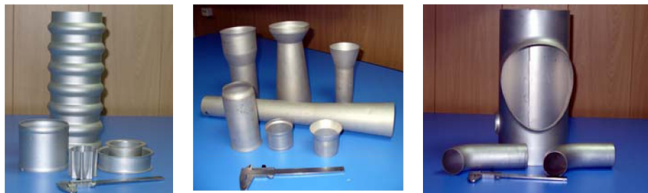
Рис. 100. Детали, полученные формовкой импульсным магнитным полем
