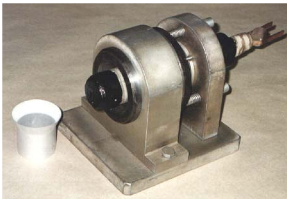
Рис. 102. Технологическая оснастка для формовки «конуса»
