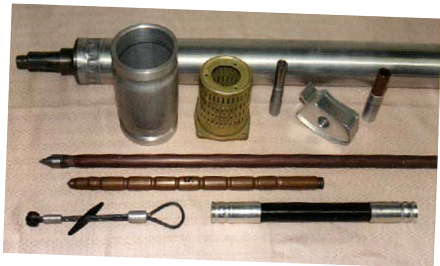
Рис. 112. Детали, полученные магнитно-импульсной сборкой
