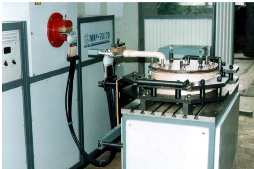
Рис. 104. Подключение индуктора к установке гибким кабелем
