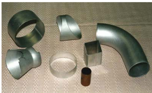
Рис. 96. Образцы деталей, полученных с использованием операций магнитно-импульсной резки
