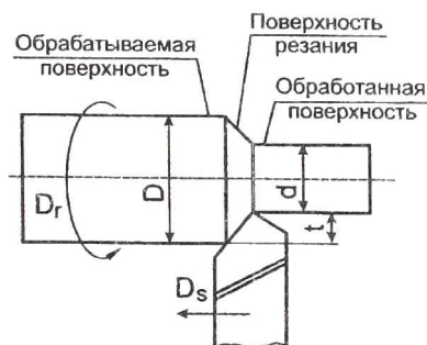
Рис. 1.1. Основные поверхности заготовки и основные движения, необходимые для осуществления процесса резания при точении
