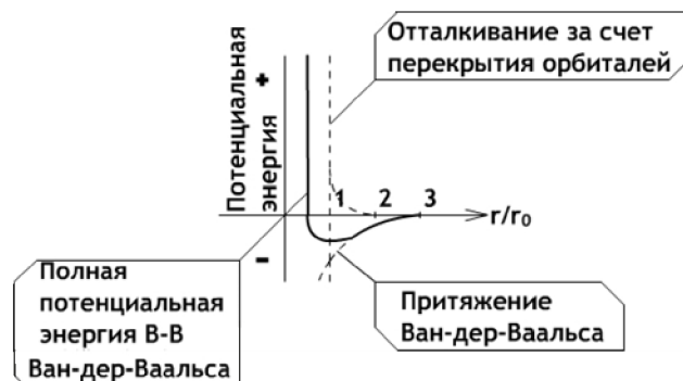
Рис.1.8. Графическое представление решения уравнения (1.2): r_0 — расстояние между атомами в равновесном состоянии, r — в текущем состоянии
