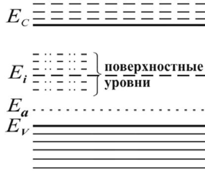
Рис. 3.11. Положение энергетических уровней в области поверхности полупроводника
