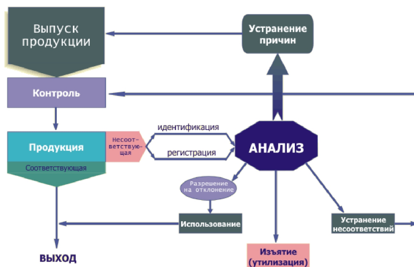
Рис. 3.12. Схема регистрации, идентификации, анализа несоответствующей продукции и принятия решений о действиях с ней
