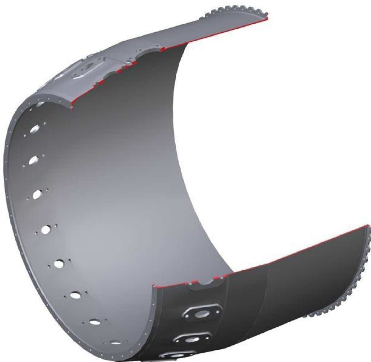
Рис. 4.3 Наружный корпус камеры сгорания (разрез объемной модели)
