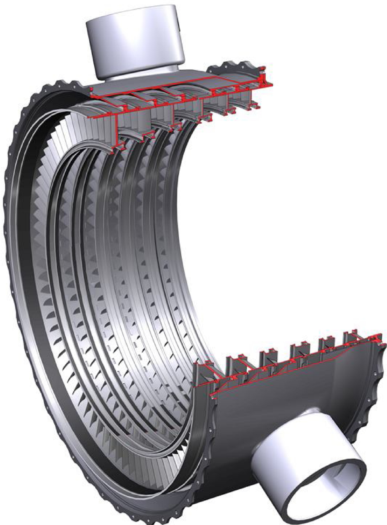
Рис. 2.24 Статор компрессора высокого давления (разрез объемной модели)
