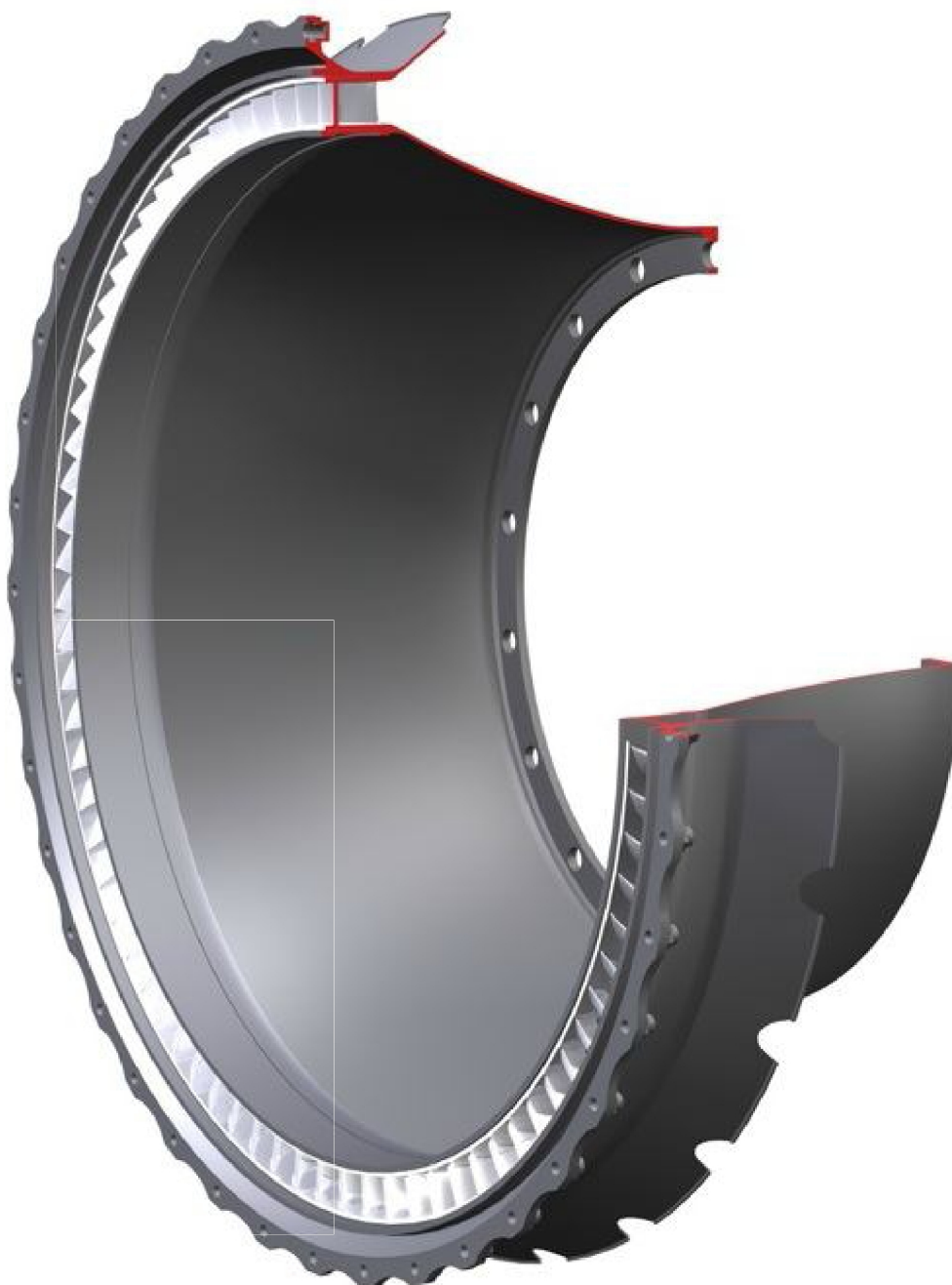
Рис. 4.5 Диффузор со спрямляющим аппаратом ступени КВД (разрез объемной модели)
