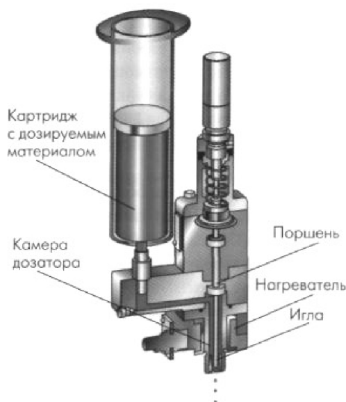
Рисунок 4.1.2 – Строение дозирующей головки
