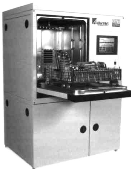
Рисунок 4.4.3 – Внешний вид установок струйной отмывки серии SMT
