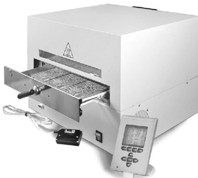
Рисунок 4.3.26 – Инфракрасно-конвекционная печь АВЕРОН АПИК 1.0
