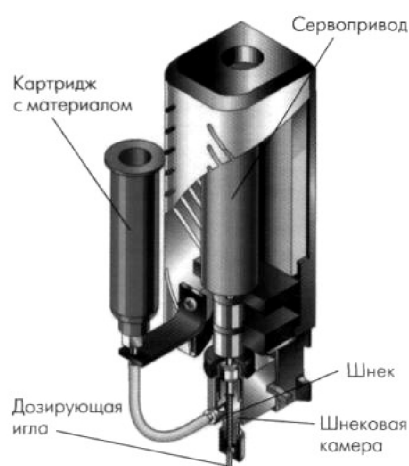
Рисунок 4.1.3 – Строение шнековой дозирующей головки
