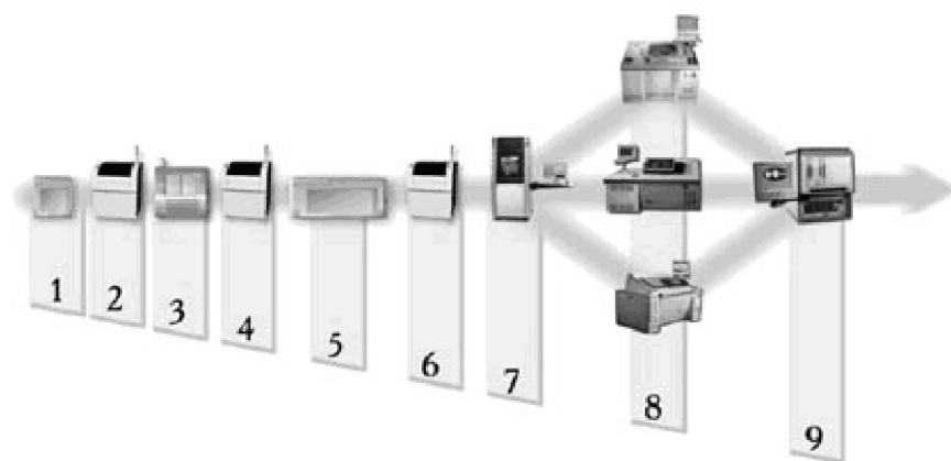
Рисунок 4.5.2 – ОАИ в производственной линии сборки печатных плат.
