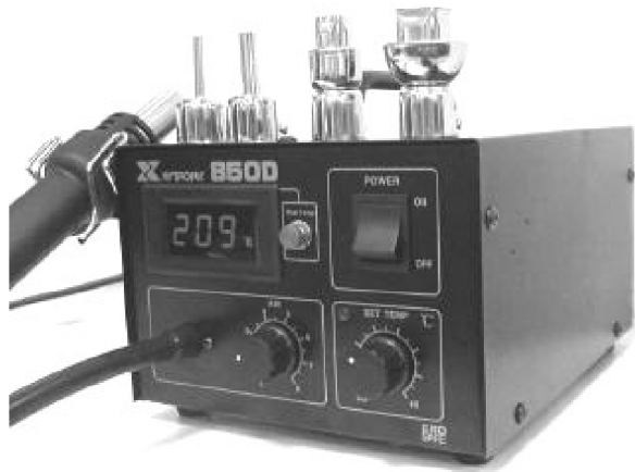
Рисунок 4.3.4 – Термофен для пайки горячим воздухом
