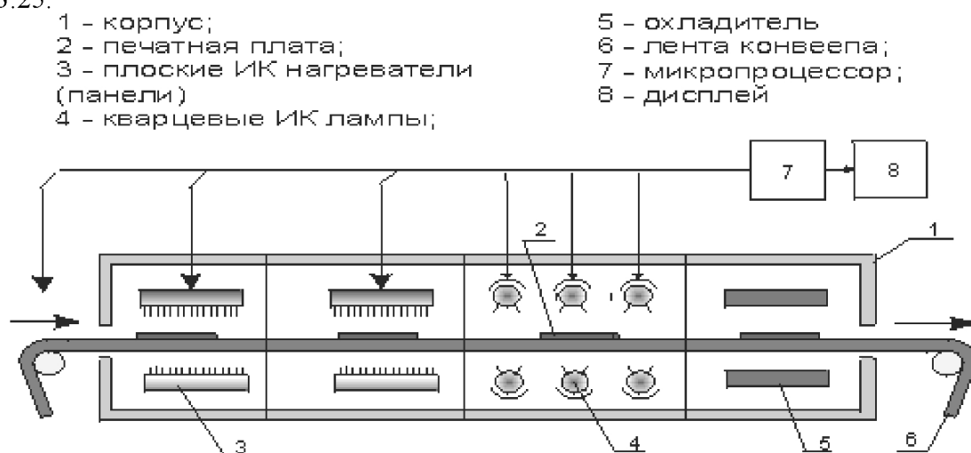
Рисунок 4.3.25. Схема конвейерной установки пайки ИК-излучением.
