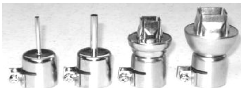
4.3.6 – Варианты насадок для различных типов микросхем
