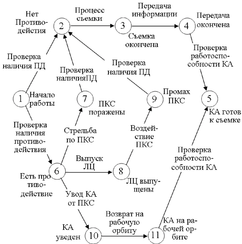
Рис. 5.6. Сетевая модель целевой работы космического аппарата наблюдения с противодействием
