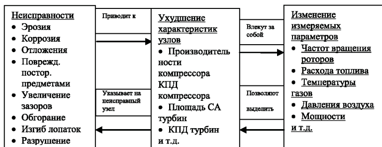
Рис. 2.6. Схема метода диагностирования ГТД по ГТД параметрам
