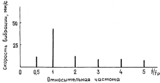
Рис. 3.20. Схематизированный спектр роторной вибрации
