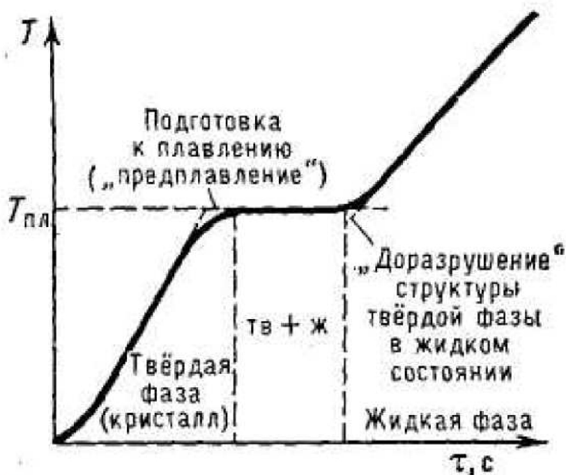
Рис. 29 Остановка изменения температуры при плавлении кристаллического тела. По оси абсцисс отложено время, пропорциональное равномерно подводимому к телу количеству теплоты.
