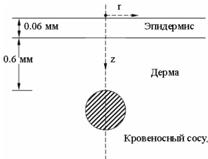
Рис. 7 Модель, учитывающая расположение кровеносного сосуда в подкожных тканях. Сосуд размещается в центре луча
