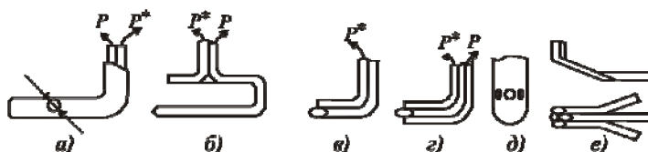
Рис. 3.10. Приемники ориентируемые для измерения \lambda и направления потока: а, б – насадки для измерения \lambda ; в, г – насадки для измерения \lambda и направления потока; д – насадок для измерения \lambda и направления потока трехточечный; е – насадок трехточечный всеобразный для измерения \lambda и направления потока в пограничном слое
