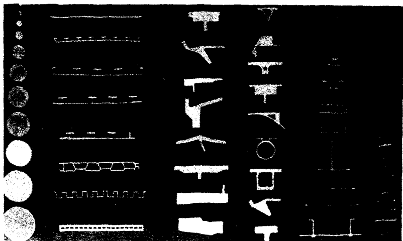
Рис. 2. Поперечные сечения типовых пресс-изделий, получаемых прессованием
