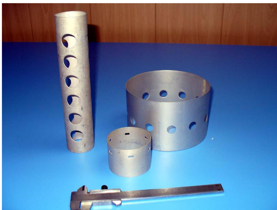
Рисунок 98 – Пробивка отверстий в деталях с использованием энергии импульсного магнитного поля
