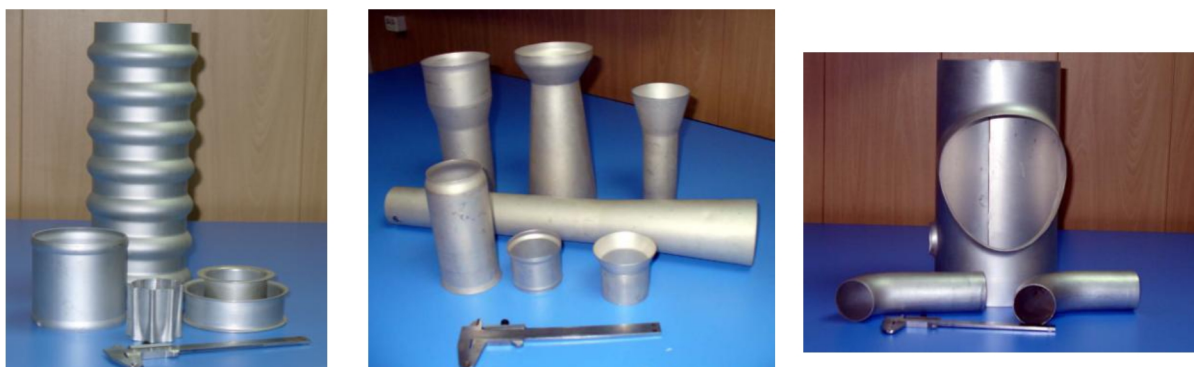
Рисунок 101 – Детали, полученные формовкой импульсным магнитным полем
