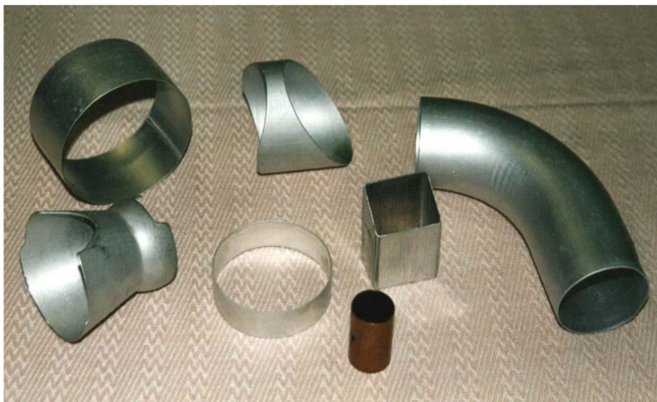
Рисунок 97 – Образцы деталей, полученных с использованием операций магнитно-импульсной резки
