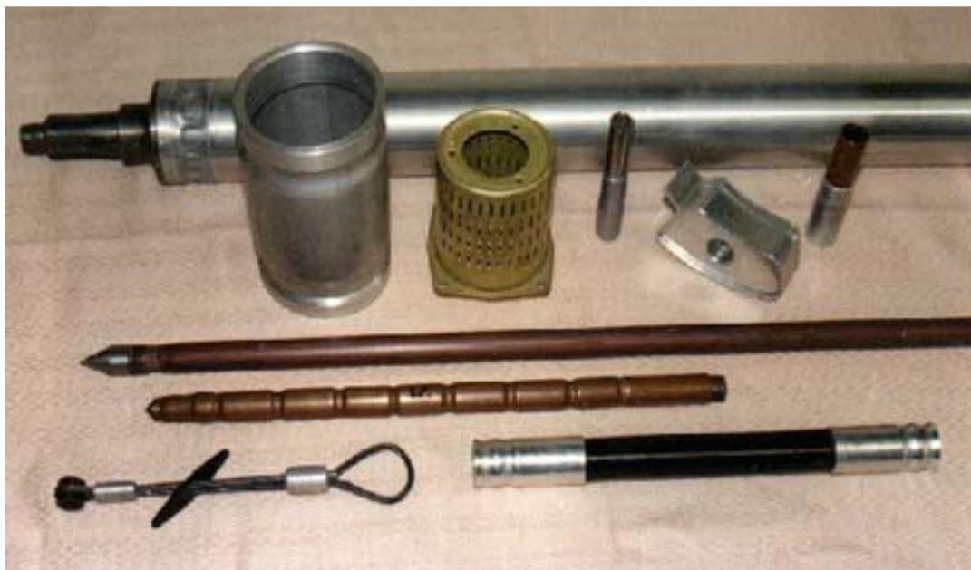
Рисунок 113 – Детали, полученные магнитно-импульсной сборкой
