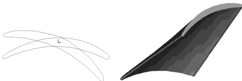
Рис. 8. Модель пера лопатки, полученная способом «Сечения»
