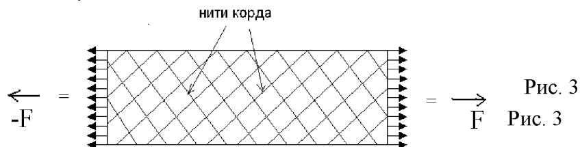
Рис. 2. Схематичное изображение резинокордного образца
