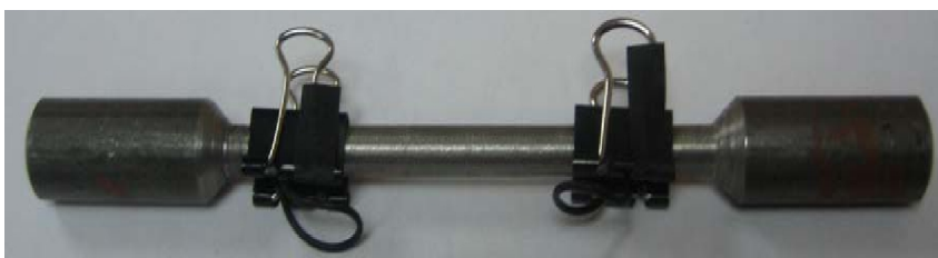
Рис. 8. Вид круглого образца с контрольными скрепками
