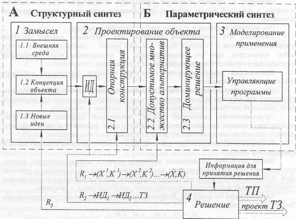
Рис. 1.4 Общая технологическая схема формирования объекта на этапе технического предложения по Рудневу В.Е.: ИД – исходные данные для предварительного проектирования; ТЗ – техническое задание на опытно-конструкторскую разработку; R_1 – управление параметрическим синтезом; R_2 – коррекция ИД и структурной схемы; R_3 – коррекция замысла; (X^i, K^i) – корректирующие характеристики и конструктивные параметры объекта при i -й итерации; (\bar{X}, \bar{K}) – характеристики и параметры в техническом предложении
