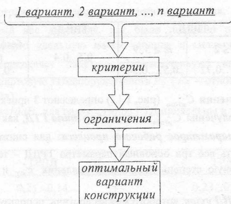
Рис. 1.10 Схема получения оптимального варианта конструкции
