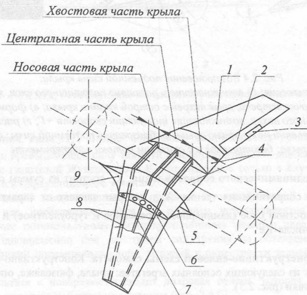
Рис. 2.6 Конструктивно-силовая схема крыла:
