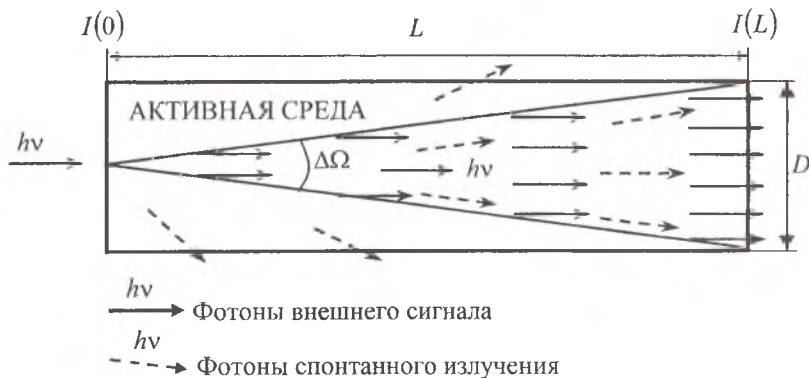
Рис. 1.15. Оптический (лазерный) усилитель. На вход в активную среду длиной L[\text{м}] и диаметром D[\text{м}] с инверсной населенностью \Delta N = N_2 - N_1 поступает внешний входной сигнал с интенсивностью I(0) = I_0 , который усиливается на длине усиления L . Спонтанное излучение эффективно усиливается лишь в пределах телесного угла \Delta\Omega = \left(\frac{D}{L}\right)^2 , так как только в пределах этого угла происхо-
