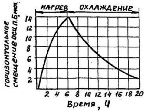
Рисунок 14 – Температурные деформации станка
