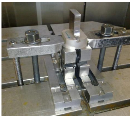
Рисунок 7 - Установка приспособления на поворотном столе станка Mikron UCP 800 DURO
