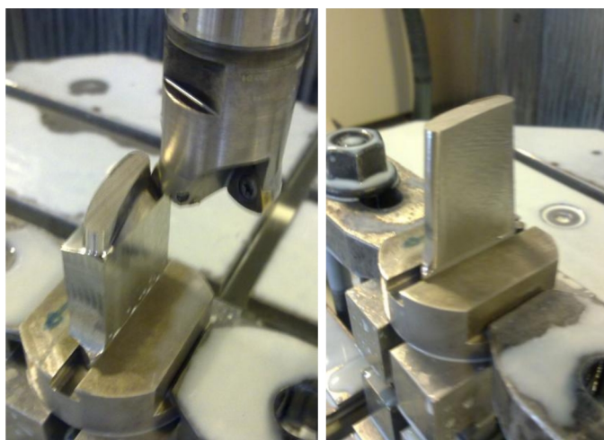
Рисунок 8 - Черновая обработка пера лопатки
