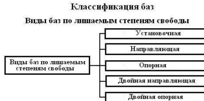
Рисунок 12 - Классификация баз по лишаемым степеням свободы
