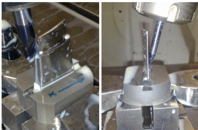
Рисунок 9 - Финишная обработка пера и прикомлевого участка лопатки
