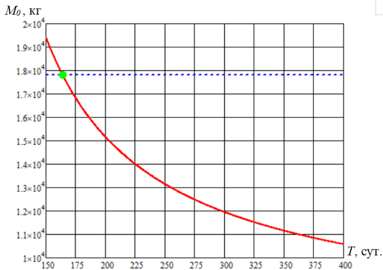
Рисунок 5.4 - Потребная масса КА на опорной орбите, в зависимости от длительности перелёта при оптимальной скорости истечения
