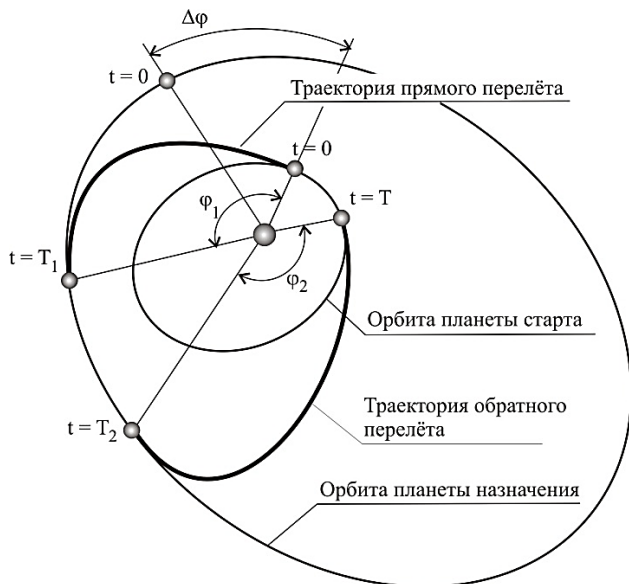
Рисунок 3.2 - Баллистическая схема межпланетного перелёта с возвращением
