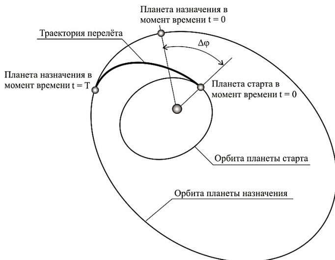
Рисунок 3.1 - Баллистическая схема межпланетного перелёта без возвращения
