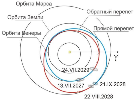
Рисунок 6.11 - Оптимальная баллистическая схема пилотируемой миссии Земля – Марс – Земля с учётом ограничения на минимальное расстояние от КА до Солнца. Рассчитано для эллиптических некомпланарных орбит планет
