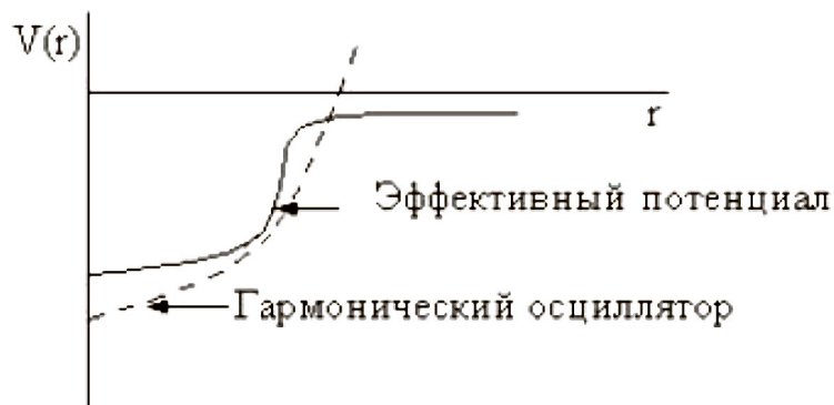
Рис. 25. Аппроксимация реалистичного потенциала потенциалом гармонического осциллятора
