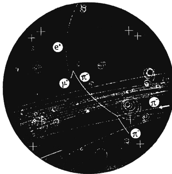
Рис. 17. Типичная фотография распада пи-мезона. Пришедший снизу пи-мезон родил мю-мезон, а тот рядом же, просуществовав миллионные доли секунды, родил электрон. Моментам распадов отвечают два ясно видимых излома следов
