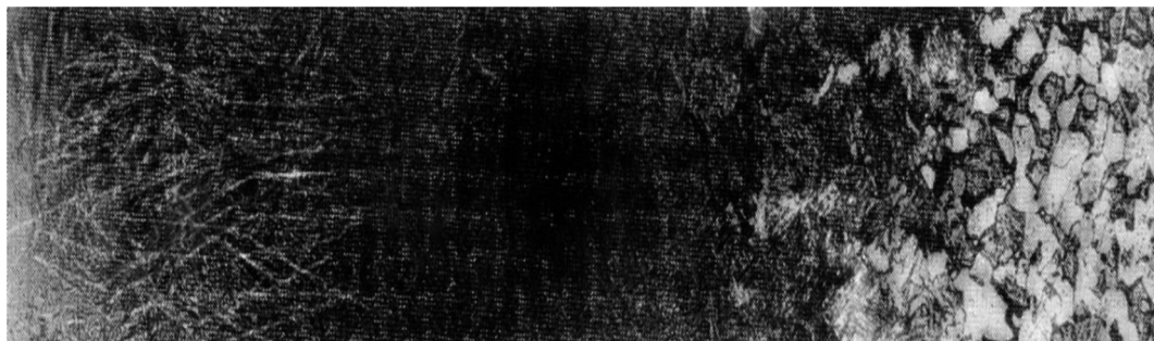
Рис. 45 Микроструктура поверхности детали после цементации и термообработки
