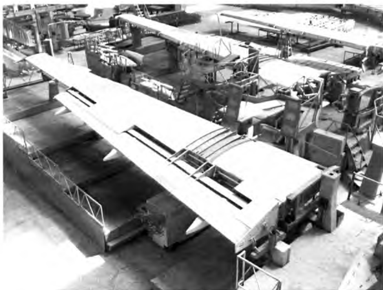
Рис. 10.1. Стенд для навески закрылков на ОЧК
