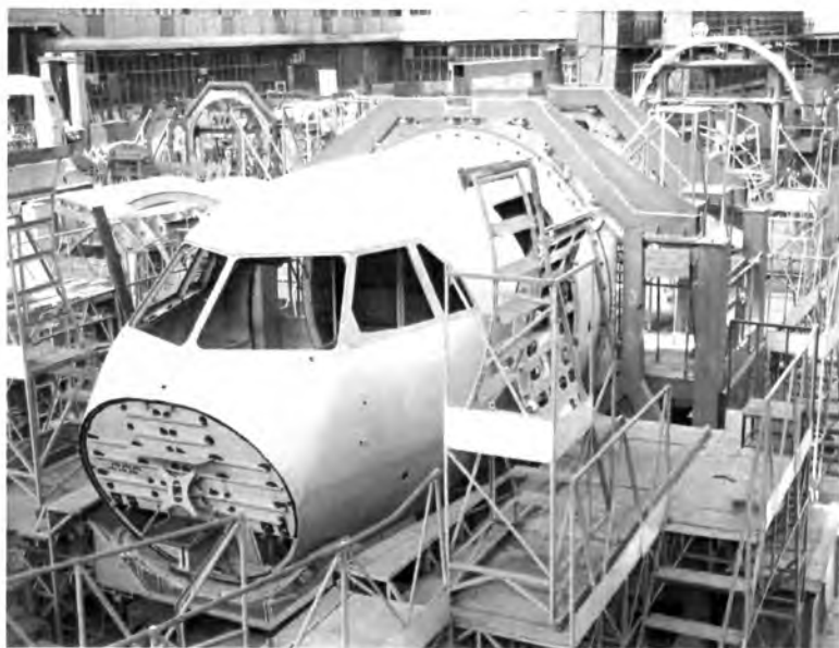
Рис. 10.3. Приспособление для стыковки верхней и нижней частей Ф-1
