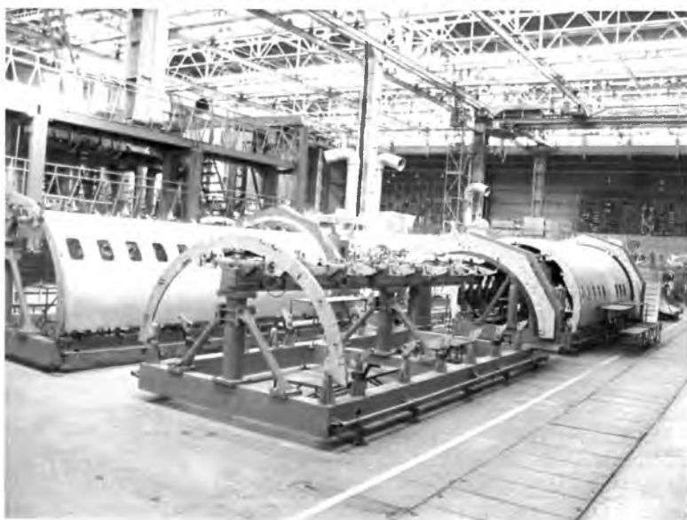
Рис. 10.4. Приспособление для сборки верхних панелей Ф-2
