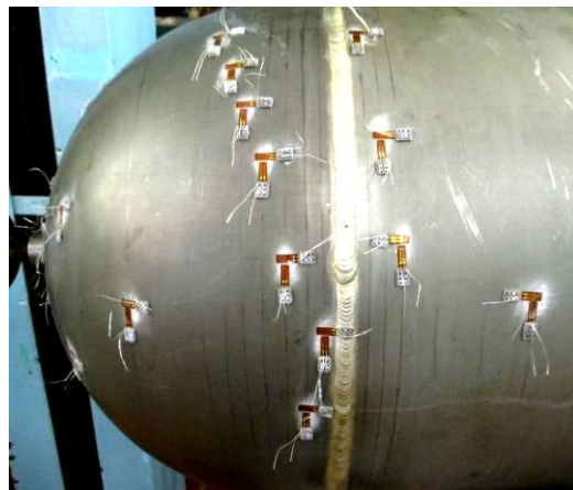
Рис. 83 – Расположение тензорезисторов в зоне сварного шва
