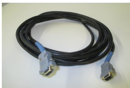
Рис. 10 – Кабель, соединяющий модуль ИС с хост-контроллером
