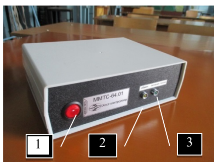
Рис. 15 – Внешний вид хост-контроллера со стороны передней панели (слева) и задней панели (справа): 1 – сетевой выключатель; 2 – индикатор состояния обмена информации по линии RS-485; 3 – индикатор линии питания, подключающей модуль MMTC-64.01; 4 – разъём для подключения кабеля, соединяющего модуль MMTC-64.01; 5 – USB-разъём для подключения к компьютеру; 6 – сетевой разъём для подключения питания 220 В
