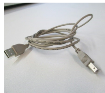
Рис. 16 – USB-кабель, соединяющий хост-контроллер с ноутбуком
