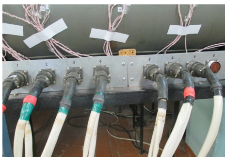
Рис. 7 – Электрические кабели, соединяющие тензорезисторы лабораторной установки с измерительным модулем MMTC-64.01
