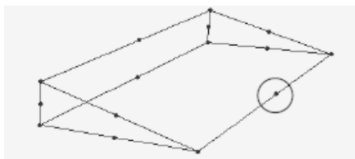
Рисунок 66 – Элемент с одним узлом вдоль линии трещины
