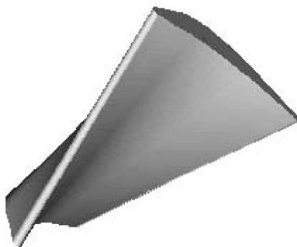
Рис. 2.5.3. Модель пера – результат операции "БЭФ Сечения"
