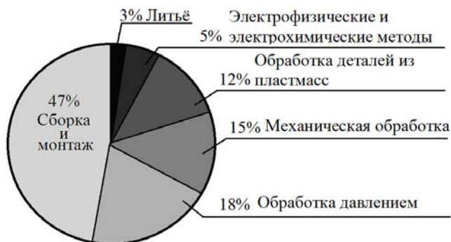
Рис. 4.1 – Трудоёмкость основных технологических процессов изготовления деталей РЭС
