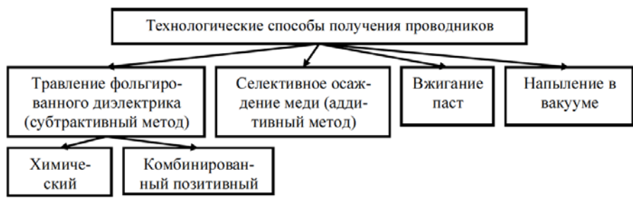
Рис. 2.4 – Способы получения проводников
