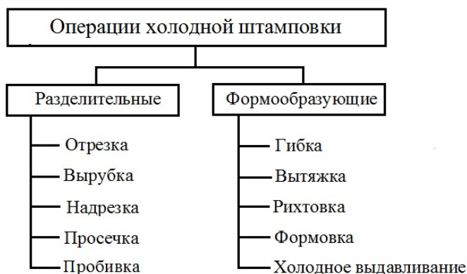
Рис.4.4 – Операции холодной штамповки
