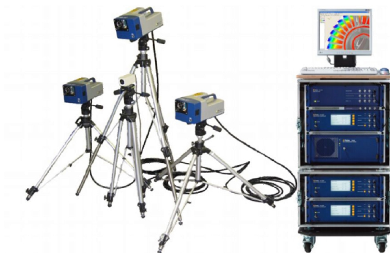
Рисунок 6.1 - Комплекс дистанционного 3-D виброметрирования
