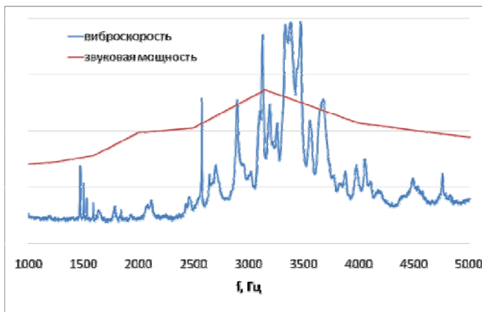
Рисунок 6.3 - Корреляция параметров вибрации каталитического коллектора и излучаемого им шума
