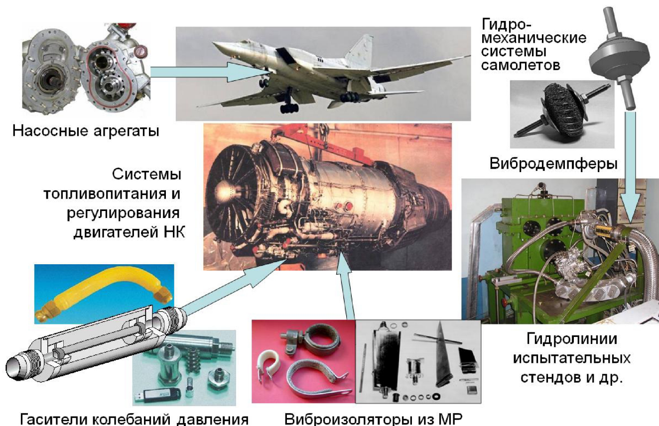
Рисунок 3.1 - Снижение виброакустических нагрузок в авиационных гидравлических и топливных системах
