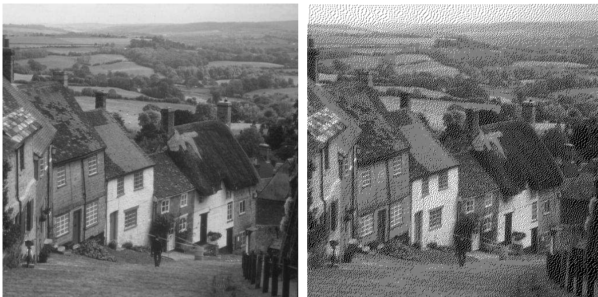
Рис. 4.3 – Пример работы алгоритма диффузии ошибки для растривания полутонового изображения
