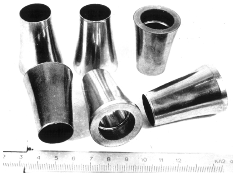
Рис. 55. Порошковые втулки с тонкой стенкой из ПЖВ2.160.28
