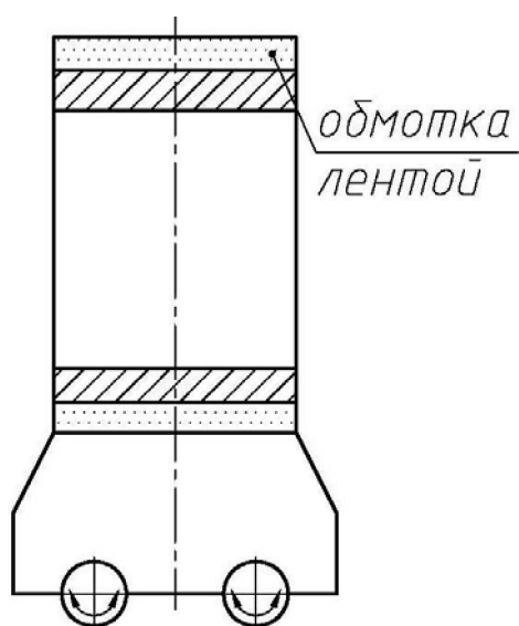
Рис. 79. Подвижная рама станины газостата
