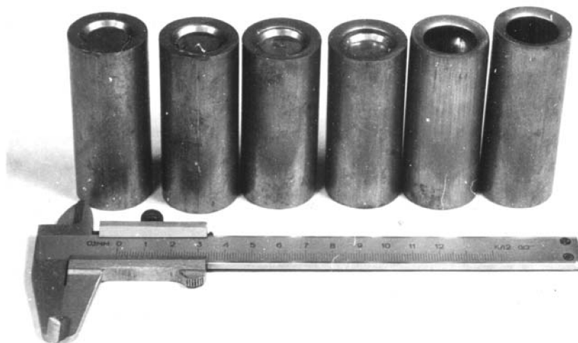
Рис. 30. Поэтапное формоизменение спеченной порошковой заготовки при выдавливании из нее стакана при активном действии сил трения
