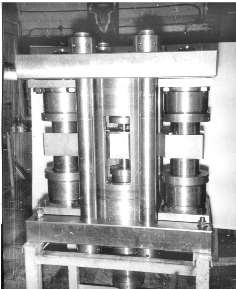
Рис. 16. Пресс для выдавливания с активными силами трения
