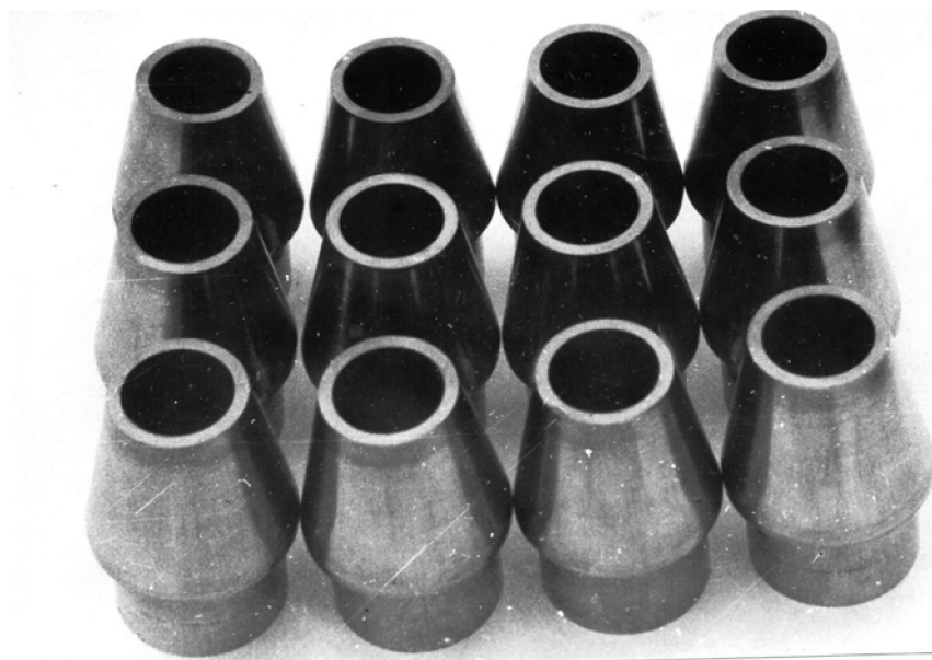
Рис. 56. Порошковые втулки со ступенчатой фланцевой частью из ПЖРВ3.160.24
