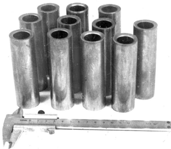
Рис. 31. Стаканы, изготовленные выдавливанием из спеченных порошковых заготовок
