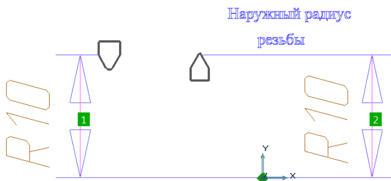
Рисунок 2.5 – Параметрические модели резцов для нарезания резьбы на стержне (слева) и в отверстии (справа)
