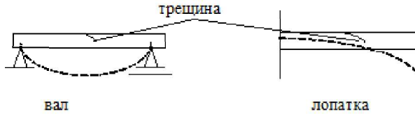
Рис.2.14. Схема балки с трещиной
