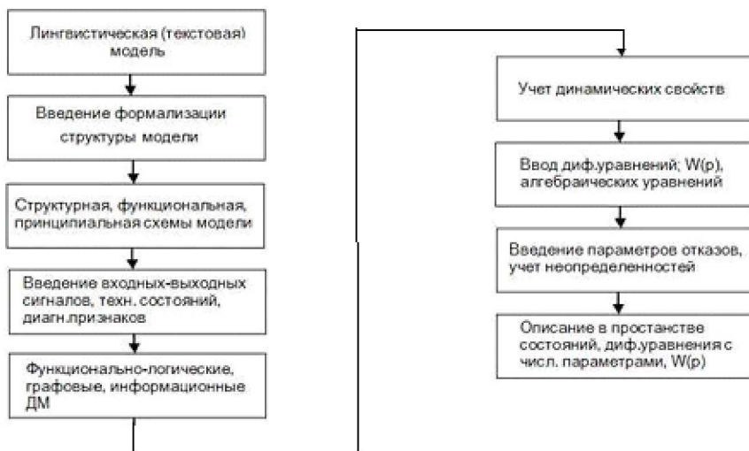
Рис. 2.1. Иерархия диагностических моделей
