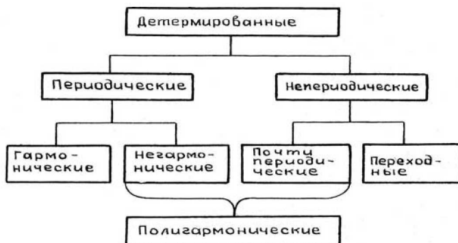
Рис. 3.1. Классификация детерминированных колебательных процессов
