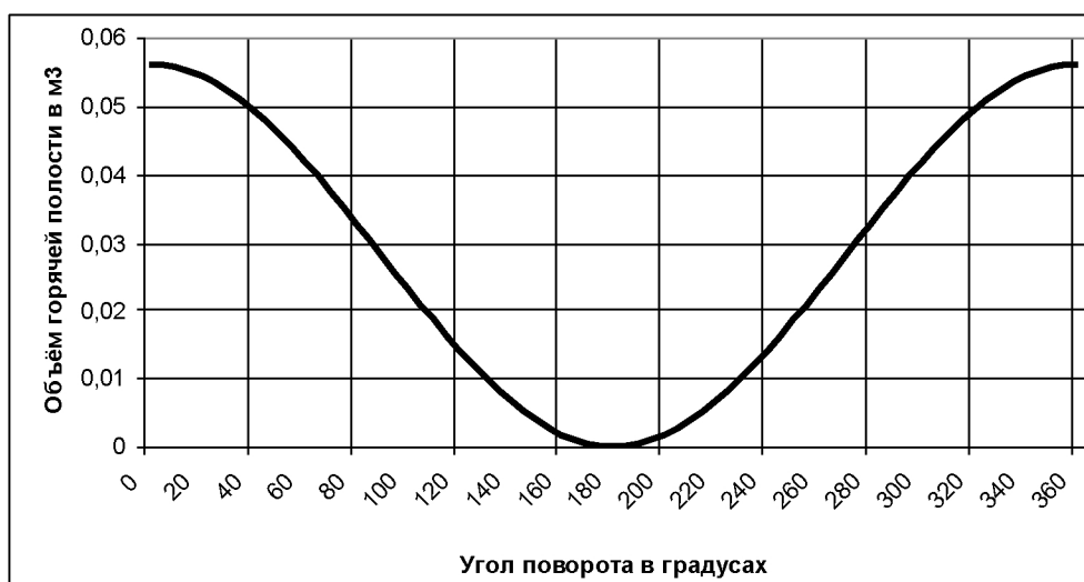
Рис. 6 Зависимость объёма горячей полости от угла поворота
