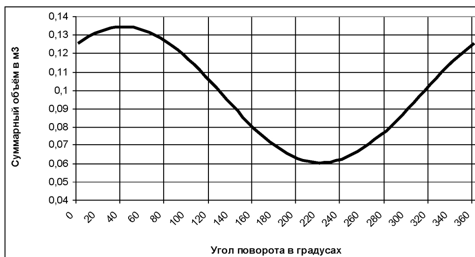
Рис. 8 Зависимость суммарного объёма от угла поворота
