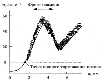
Рис. 1.20. Сравнение измеренных значений скорости потока методом пробных частиц (точки) с вычисленными значениями скорости в пламени с противотоком с предварительно не перемешанной смесью: горячее поступает в точке z = 0 , воздух – в точке z = \infty
