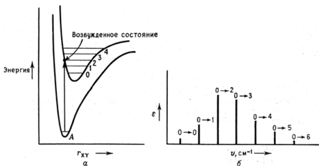
Рис.4.12. Кривые потенциальной энергии для основного и первого возбужденного состояний двухатомной молекулы XY (а); спектр поглощения двухатомной молекулы (б)
