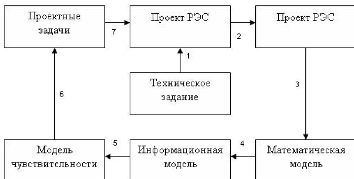
Рис.3.4. Схема процесса автоматизированного проектирования РЭС
