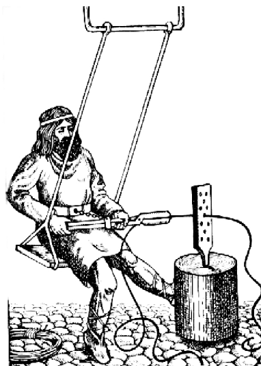
Рис. 2. Приспособление с качающимся сиденьем для волочения проволоки
