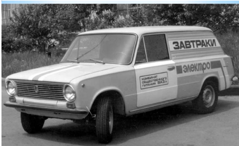
ВАЗ-2801 (1980). Первый серийный советский электромобиль. Развозной фургон на базе ВАЗ-2102 был построен в количестве 47 экземпляров и использовался в Запорожье, Киеве, Симферополе.
