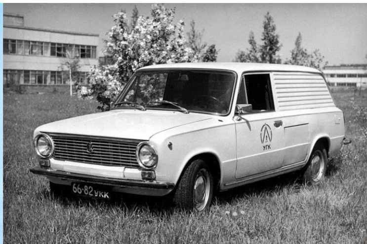
ВАЗ-2102Э (1976). Немалую часть кузова занимали батареи, но автомобили успешно использовались для развозки почты в рамках городской программы испытаний.
