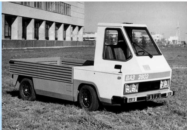
BA3-2802-01 «Пони» (1979). Развозной фургончик, разработанный с использованием элементов BA3-1801 для народного хозяйства СССР. Автомобиль имел грузоподъёмность 450 кг.
