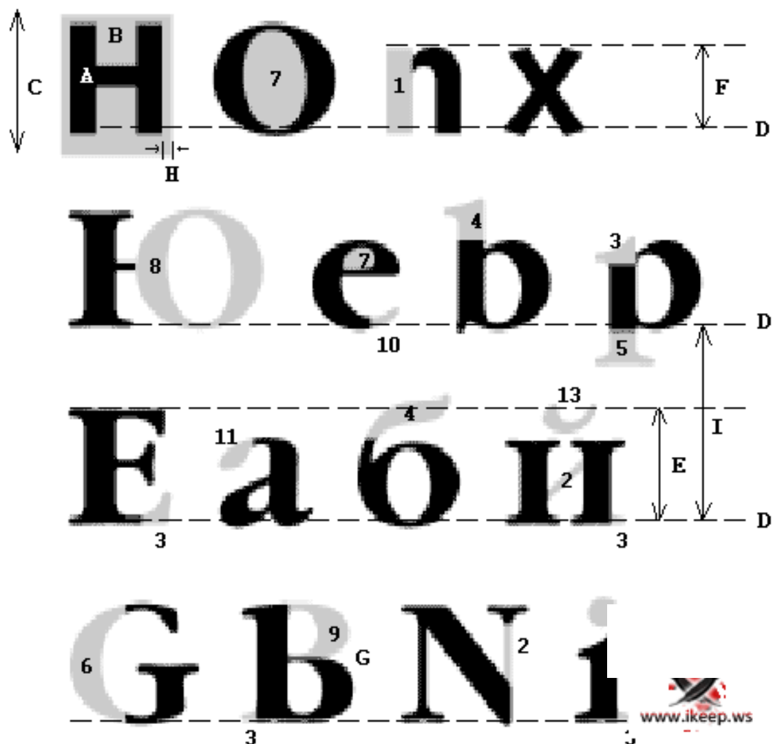
Рис. 6. Параметры и элементы очка знаков шрифта
