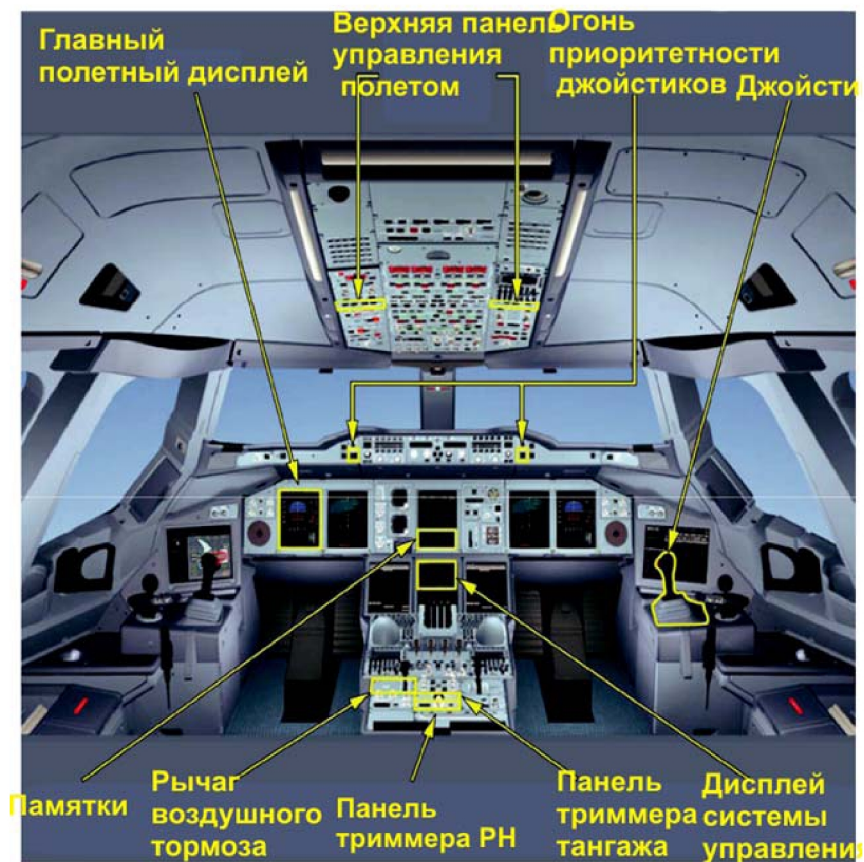
Рис. 1.12 Элементы управления и контроля
