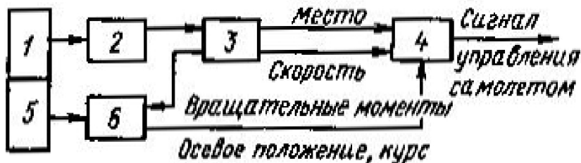
1 – акселерометры; 2 – гироскопы; 3 – стабилизированная платформа; 4 – навигационная ЭВМ; 5 – ЭВМ управления
