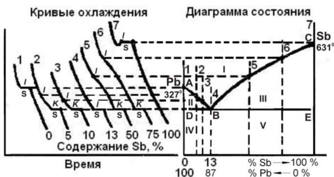
Рис. 29. Построение диаграммы состояния по кривым охлаждения
