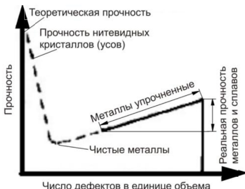
Рис. 13. График зависимости прочности кристалла от количества дефектов в решетке
