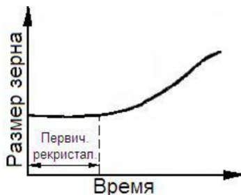
Рис. 27. Зависимость величины зерна от продолжительности нагрева
