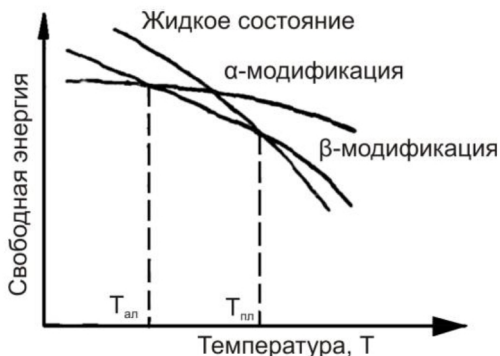
Рис. 5. Изменение свободной энергии жидкого и кристаллического состояния в зависимости от температуры
