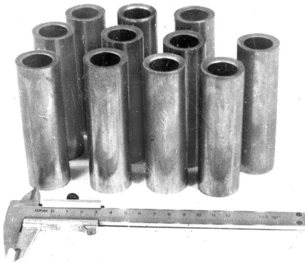
Рис. 22. Стаканы, изготовленные выдавливанием из спеченных порошковых заготовок
