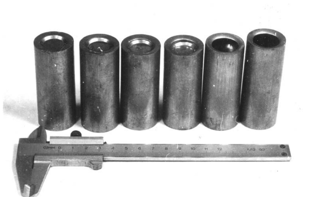
Рис. 21. Поэтапное формоизменение спеченной порошковой заготовки при выдавливании из нее стакана при активном действии сил трения
