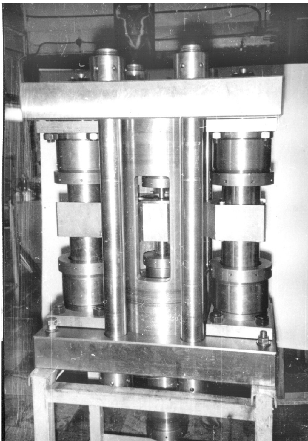
Рис. 11. Пресс для выдавливания с активными силами трения
