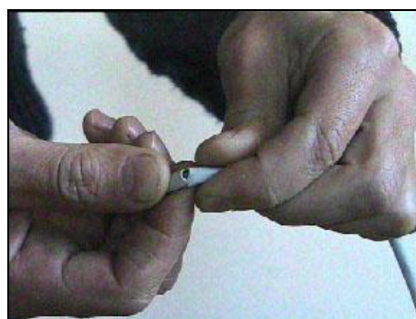
2. Удаление наружной изоляции по кольцевому надрезу
